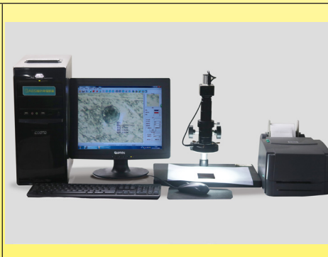
凹痕直径电子显微镜测量 (Ultimheat 实验室)
